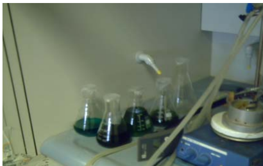
Fig. 3 Frațiile de ftalocianină formată în exteriorul azeolitului, extrase cu acetonă, metanol, acetonitril
